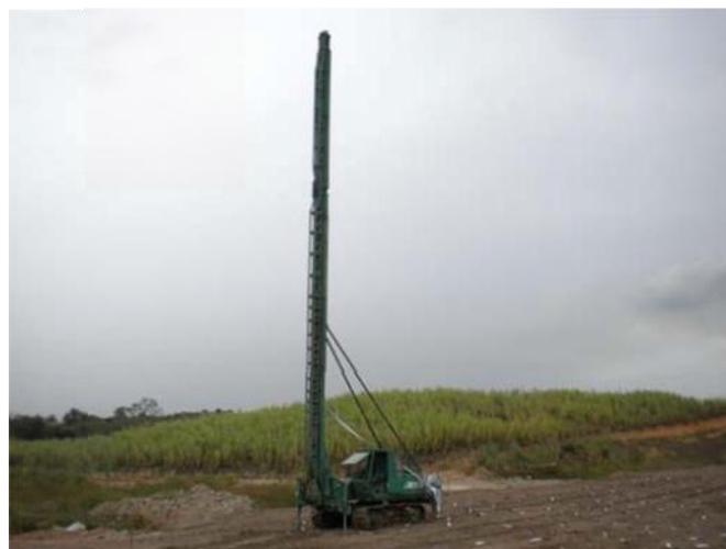
Figura 3.19 - Método utilizado para cravação do geodreno
