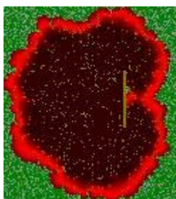
Figura 3.6: Comportamento do fogo diante da presença de um aceiro, representado por uma linha de cor oliva. Vemos que o fogo contorna o aceiro, e mantém sua geometria circular.
