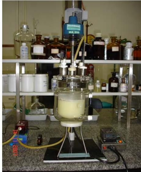
Figura 2.1 - Biorreator contendo efluente lácteo para obtenção do consórcio microbiano
