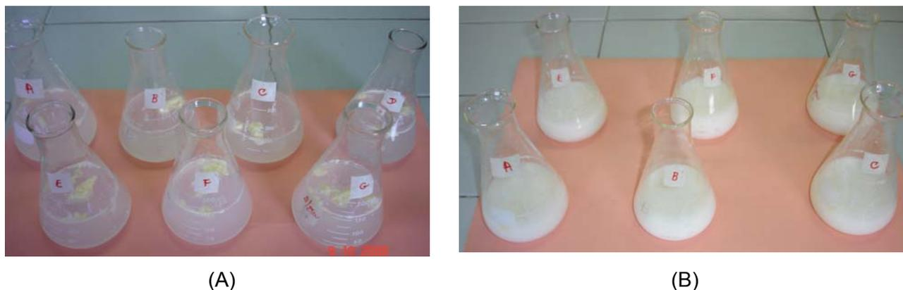
Figura 3.9 – Fotos do experimento de hidrólise. (A) antes da hidrólise e (B) após 48h de hidrólise
