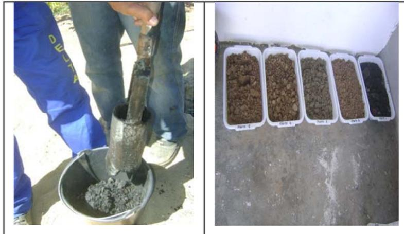
Figura 3. 21 - Coleta e tratamento das amostras do solo- Fonte: Autor em 29/05/2012
