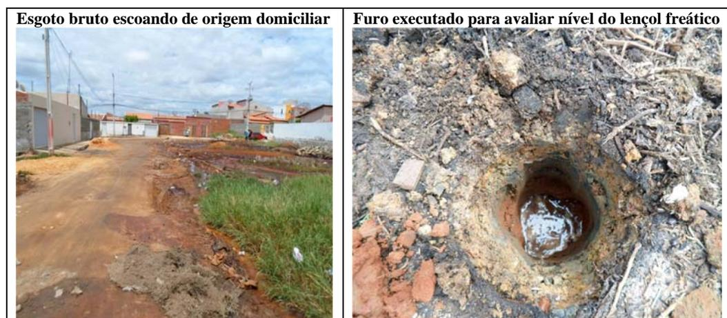
**Figura 3. 11 - Esgoto a céu aberto e nível do lençol freático próximo ao Raso da Catarina - Fonte: O autor**
