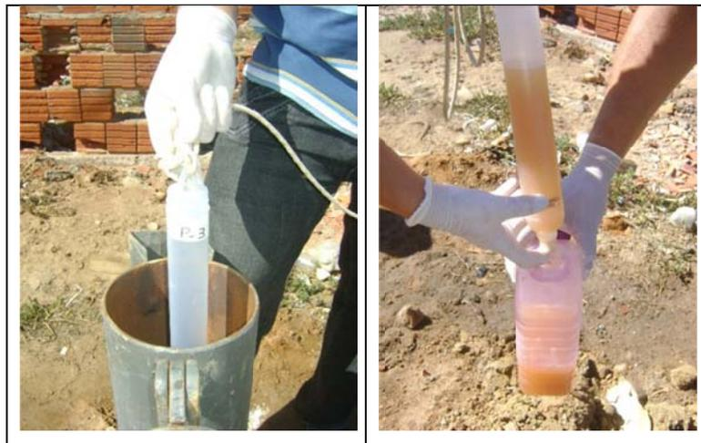
Figura 3. 22 - Coleta das amostras da água subterrânea- Fonte: O autor em 18/07/2012
