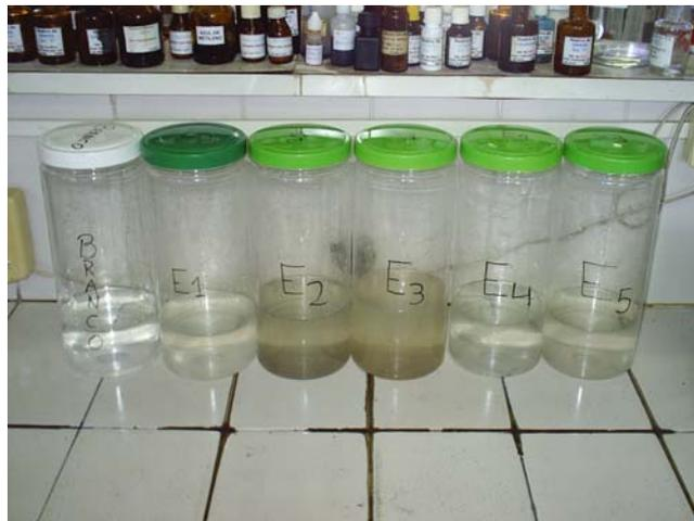
Foto 3.17 – Soluções dos frascos coletores somadas às águas de lavagem dos frascos, dos cilindros e das gazes de cada estação de monitoramento.
