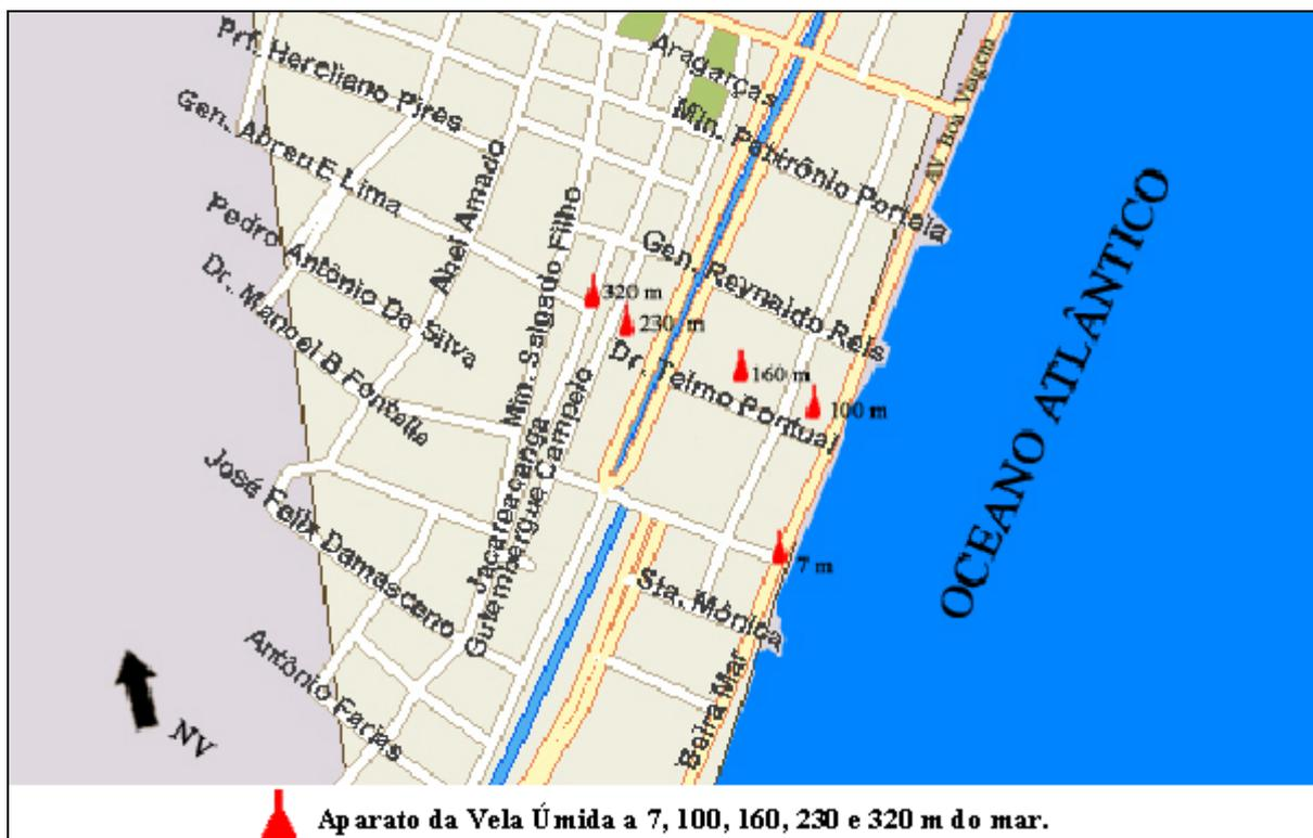
Figura 3.3 – Representação esquemática da distribuição das zonas de exposição do aparato da vela úmida.
