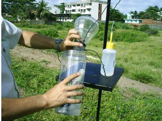
Foto 3.10 – Coleta da água de lavagem do frasco coletor.
