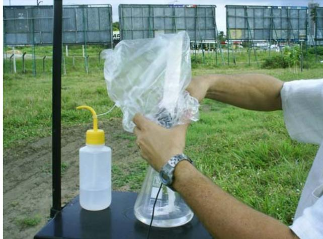
Foto 3.12 – Instalação da vela úmida no frasco coletor.
