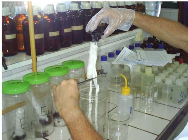
Foto 3.14 – Retirada da gaze para lavagem com água desmineralizada.
