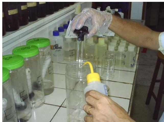
Foto 3.15 – Lavagem do cilindro com água desmineralizada.
