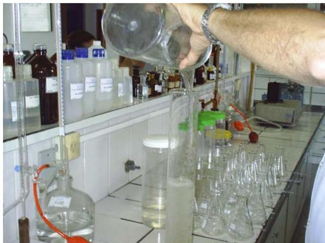
Foto 3.18 – Colocação da solução com as águas de lavagem na proveta para verificação do volume total.
