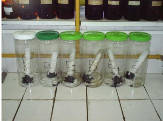
Foto 3.13 – Material completo da coleta (vela úmida, solução e águas de lavagem do frasco).
