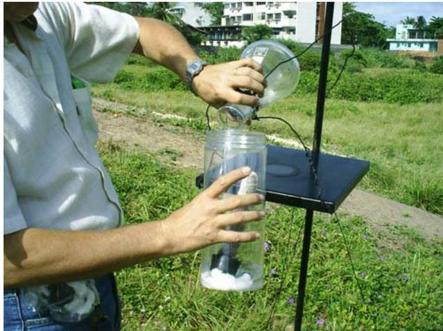
Foto 3.8 – Coleta da vela úmida e da solução do frasco coletor.
