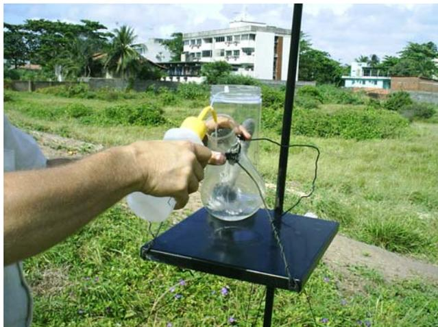
Foto 3.9 – Lavagem do frasco coletor com água desmineralizada.
