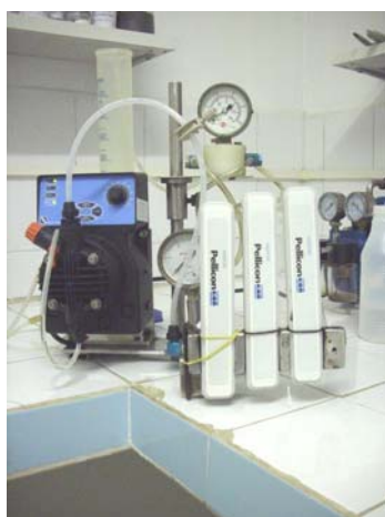
Figura 1 Equipamento de ultrafiltração
