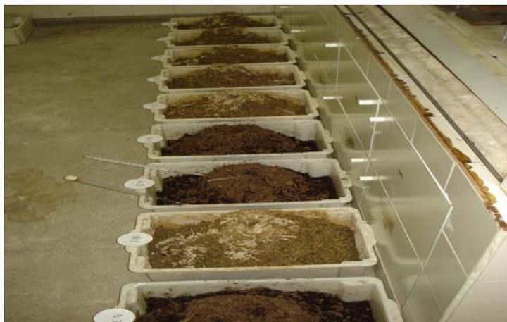
**Figura 1** Pilhas de compostagem em experimento de laboratório
