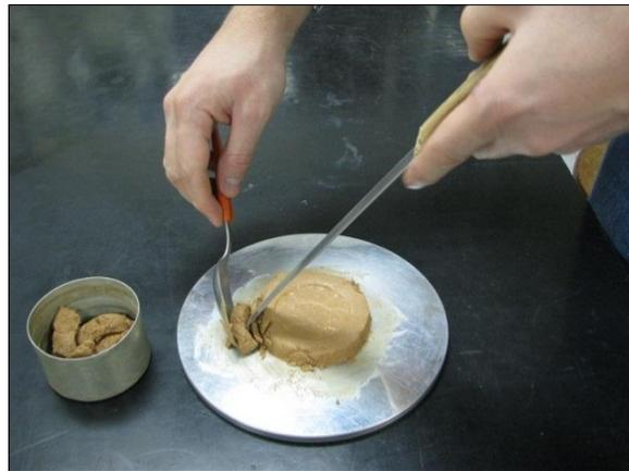
Figura 3.6. Retirada do material para secagem em estufa (imagem do autor).
