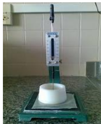
Fig. A8 – Aparelho de Vicat c/ agulha
