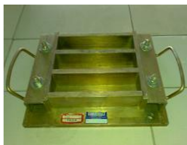
Fig. A6 – Fôrma prismática 4 \times 4 \times 16 \text{ cm} para ensaios de tração na flexão em argamassa EN-196 - NBR 13279-05
