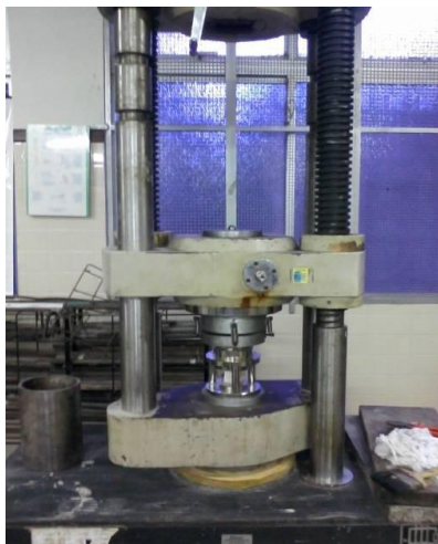
Figura 2.4 - Prensa hidráulica universal de Ensaaios (Contenco – Pavitest) utilizada nos testes de compressão do compósito gesso-polímero
