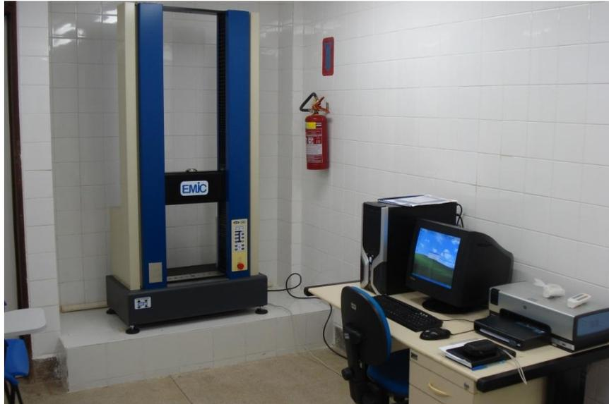
Figura 2.2 - Máquina universal marca EMIC modelo DL 10000 instalada no CT-Araripe
