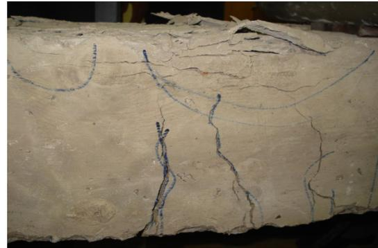
Figura 4.3: Ruptura das vigas com concreto com 100% de RCD
