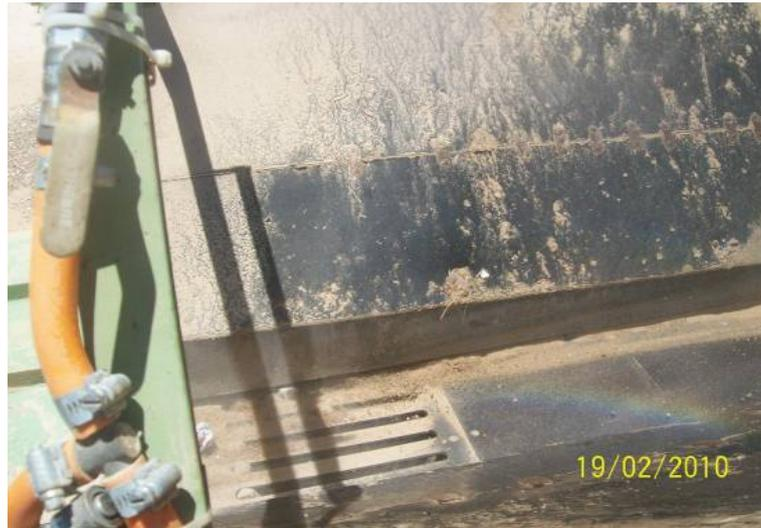
Figura 3.3: Grade de separação de finos com aspersores
