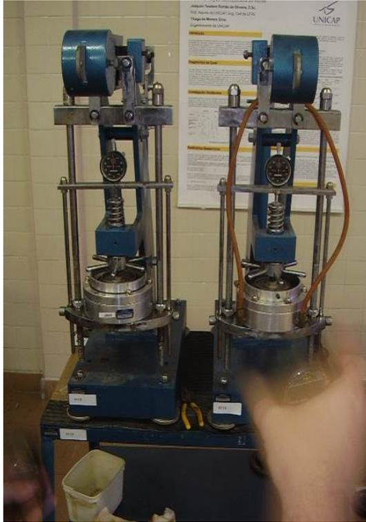
Figura 3.19: Ensaio de compressão edométrica: prensa edométrica
