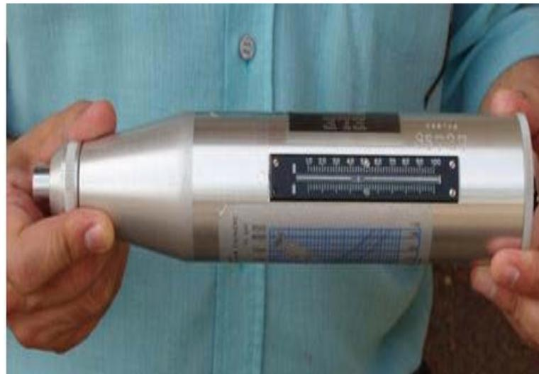
Figura 3.10: Esclerômetro de reflexão
