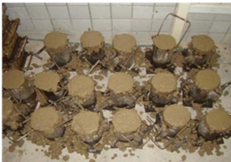
Figura 3.8: Moldagem dos corpos-de-prova
