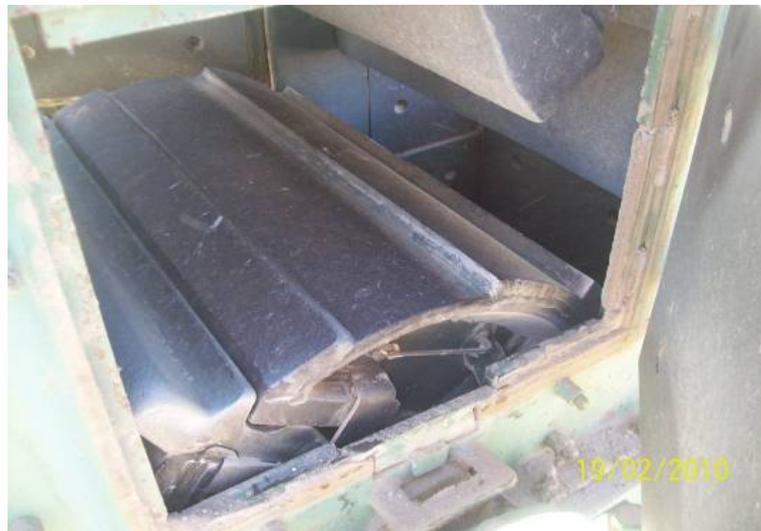
Figura 3.4: Britador de mandíbulas
