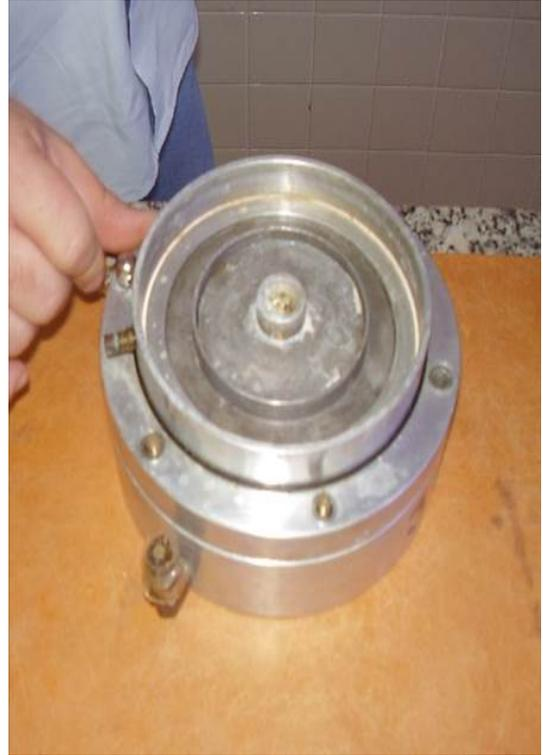
Figura 3.20: Ensaio de compressão edométrica: célula edométrica
