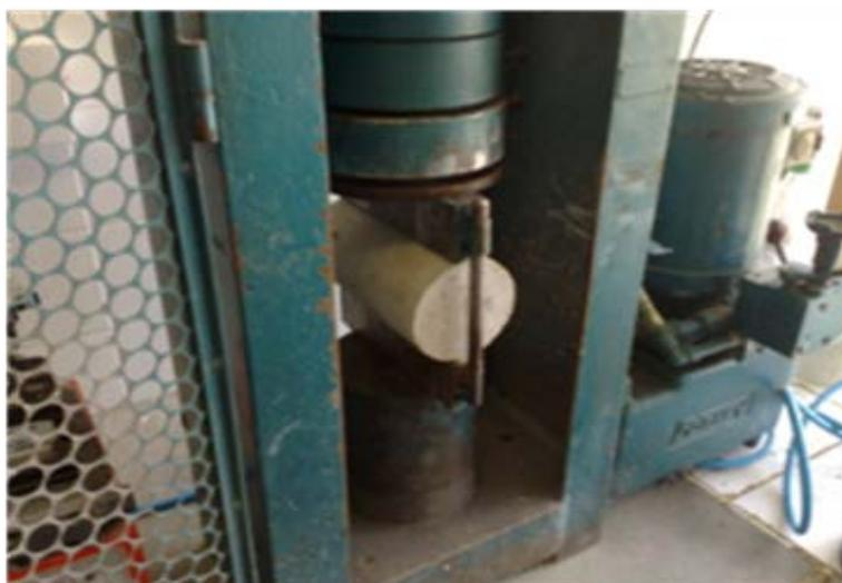
Figura 3.12: Ensaio de tração por compressão diametral
