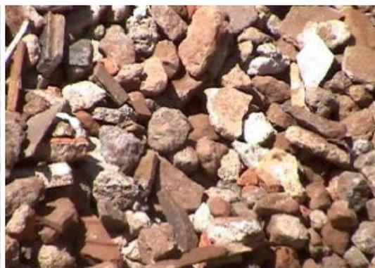
Figura 2.4: RCD vermelho da usina de Itaquera
