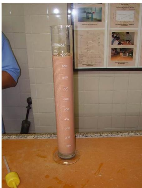
Figura 3.16: Ensaio de granulometria: sedimentação
