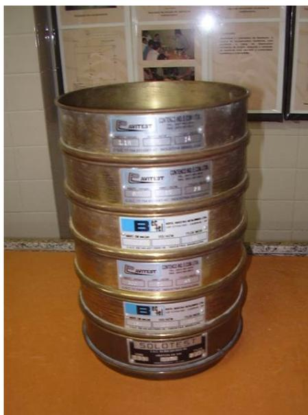
Figura 3.17: Ensaio de granulometria: peneiramento
