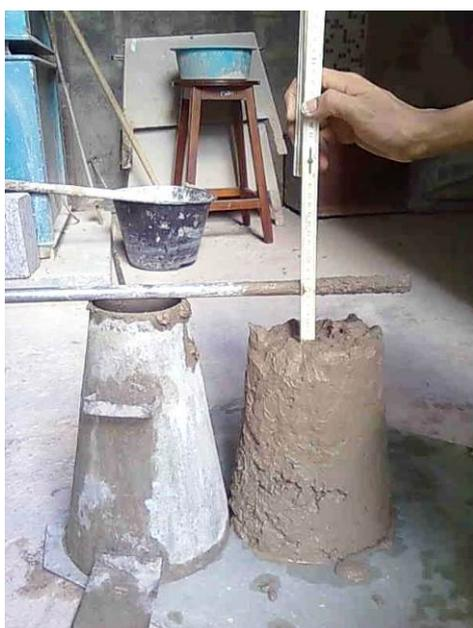
Figura 3.6: Ensaio de abatimento do concreto de referência
