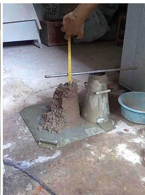
Figura 3.7: Ensaio de abatimento do concreto com agregado reciclado
