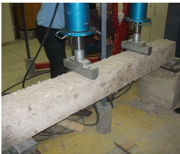
Figura 3.13: Ensaio de flexão em viga
