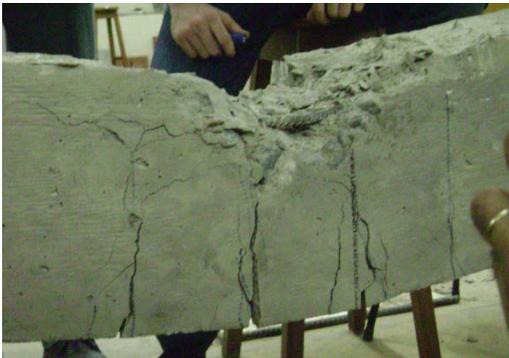
Figura 4.2: Ruptura das vigas com concreto convencional
