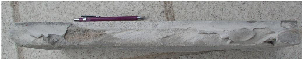
Figura n. 4.36 - Espessura da argamassa de assentamento.
