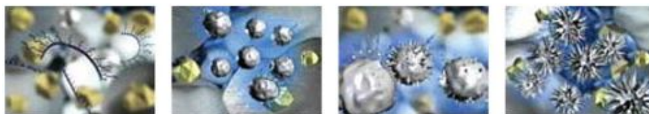
Figura 9 – Influência do aditivo na hidratação do cimento (Fonte: Basf, 2014)
