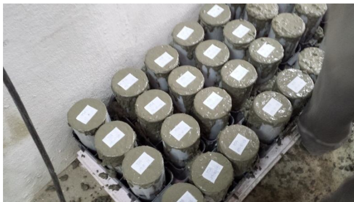
Foto 3 – Moldagem de corpos de prova cilíndrico 100 x 200 mm
