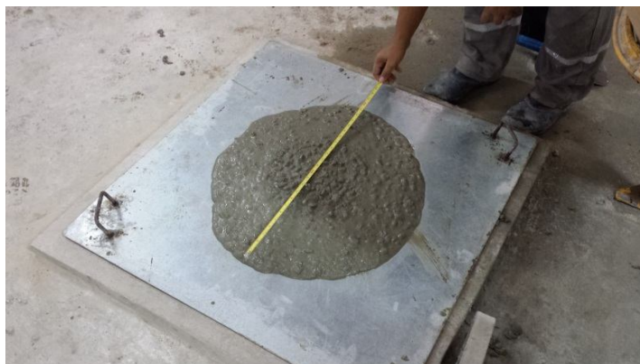
Foto 2 – Medida do espalhamento do SCC
