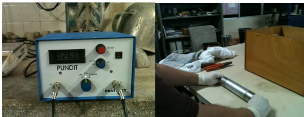
figuras 7 e 8 – Equipamento e calibração PUNDIT (Portable Ultrasonic Non-destructive Digital Indicating Tester)
