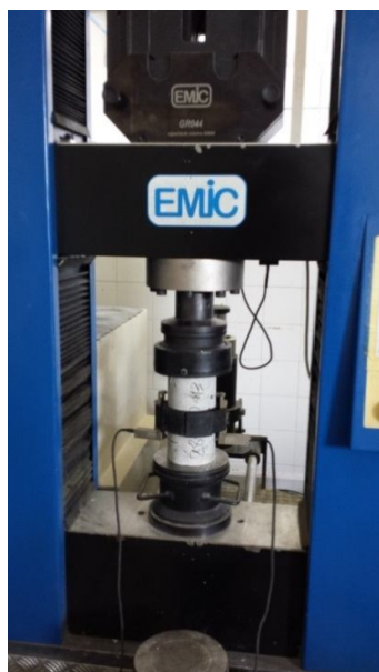
Foto 4 – Ensaio de Módulo de Elasticidade estático, segundo a ABNT NBR 8522 (2008)
