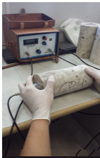
Foto 5 – Ensaio para verificação do módulo de elasticidade dinâmico direta no concreto
