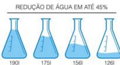
Figura 10 – Esquema ilustrativo da redução de água do hiperplastificante (Fonte: Basf, 2014)
