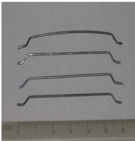
Fig. 2.11 - Fibra de aço com ancoragem em gancho e seção circular –  $l/d = 75$
