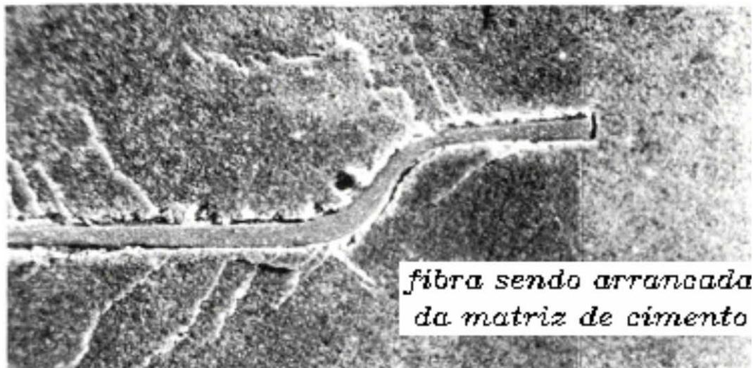
Fig. 2.9 - Fibra com extremidade em gancho, exibindo dano além da interface ao ser arrancada da matriz de cimento
