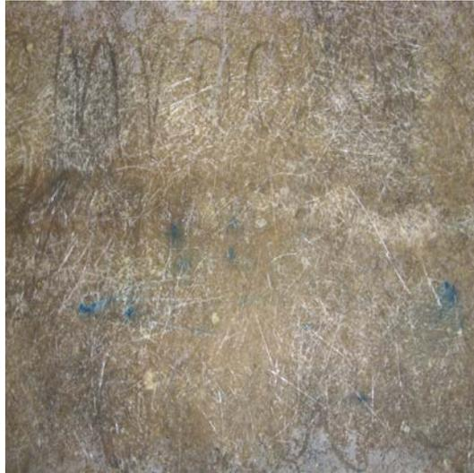
Fig. 2.5 - Fibras de vidro inseridas em matriz de resina de poliéster - laboratório de materiais - UNICAP
