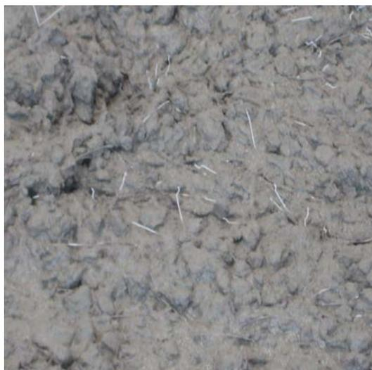
Fig. 2.21 – Concreto com adição de fibras no estado fresco
