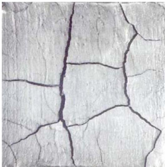
Fig. 3.9 – Fissuras de retração plástica
