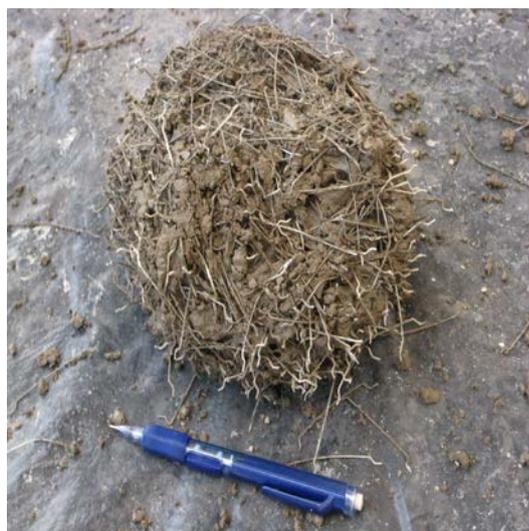
Fig. 4.2 - Ouriço – Piso Industrial no Estaleiro de Suape/PE
