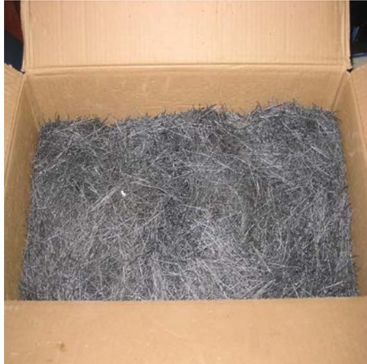
Fig. 2.6 – Fibras de aço embaladas em caixas
