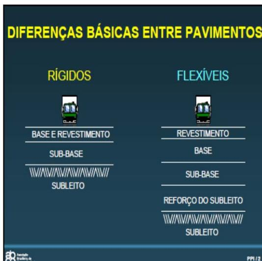
Fig. 3.1 - Diferenças básicas entre pavimentos rígidos e flexíveis
