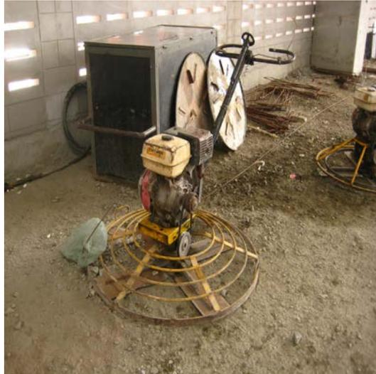
Fig. 3.13 - Acabadora mecânica
