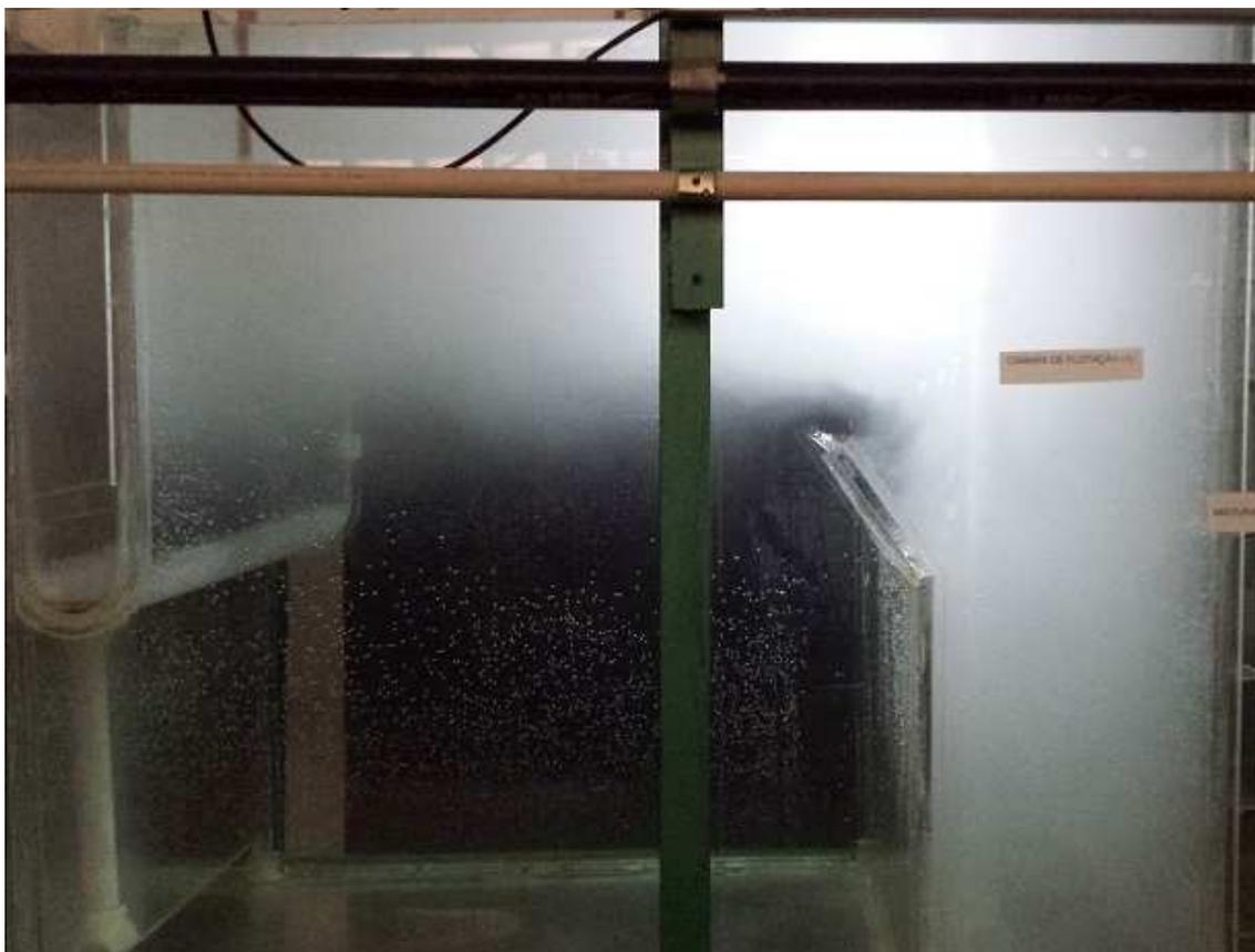
Figura 5 - Fotografia que mostra a distribuição de microbolhas numa câmara de flotação no protótipo FAD
