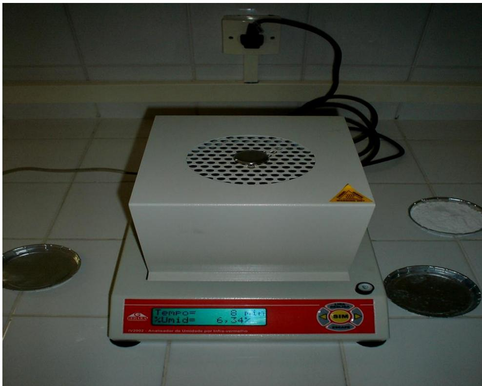
Figura 2.2 - Foto da balança térmica utilizada para determinação de água de cristalização no semi-hidrato comercial
