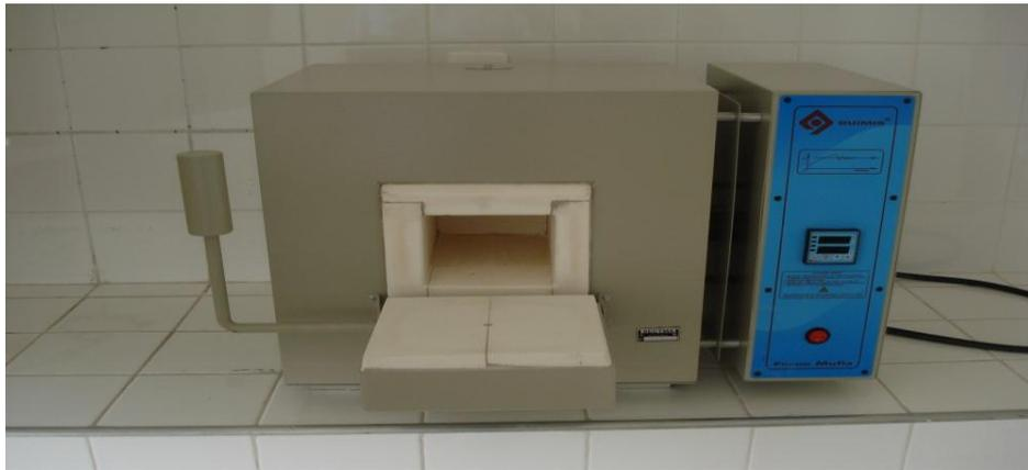
Figura 2.1 - Foto da mufla utilizada para a produção de anidrita II
