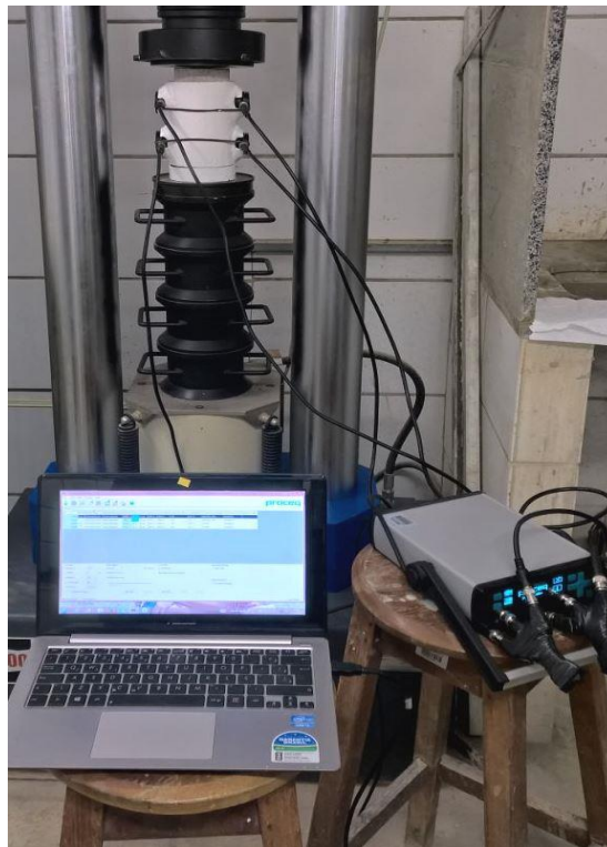
Figura 21-Esquema geral para ensaio de ultrassom com carregamento simples
