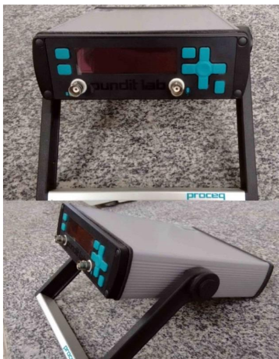
Figura 18-Equipamento de Ensaio Ultrassônico
