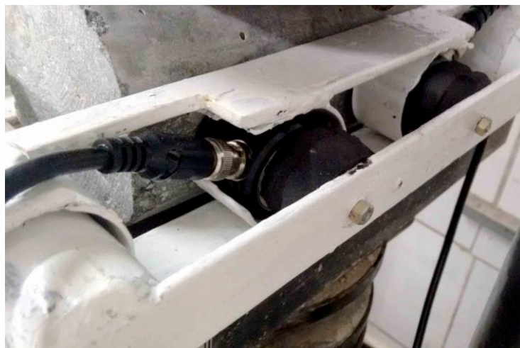
Figura 26-Detalhe da fixação dos transdutores para o ensaio de tração à compressão diametral
