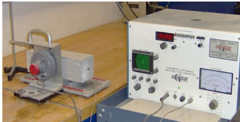
Figura 3-Equipamento medidor de frequência de ressonância com o sonómetro no ano de 1982
