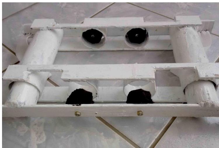
Figura 25-Molde de aço para acoplamento dos transdutores no ensaio de tração à compressão diametral
