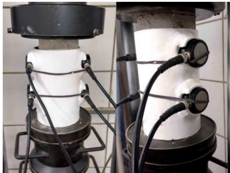
Figura 22-Fôrma de PVC para acoplar os transdutores
