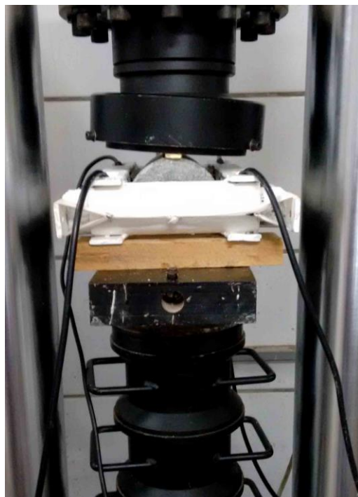
Figura 27-Esquema Geral para realização do ensaio ultrassônico com o ensaio de tração por compressão diametral
