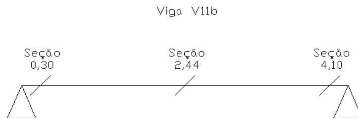
Figura 20 - Seções da viga V11b
