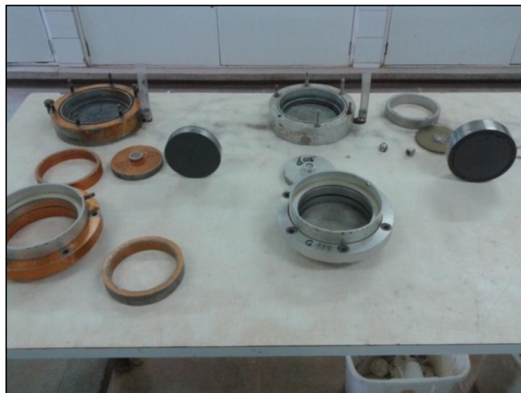
Figura 30 - Registro fotográfico das células de adensamento.
