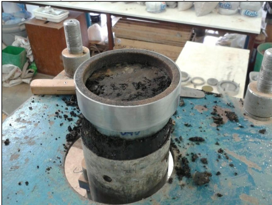
Figura 29 - Registro fotográfico dos anéis de moldagem dos corpos de prova
