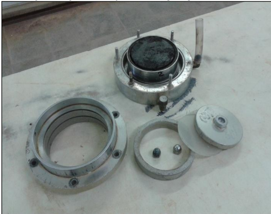
Figura 32 – Registro fotográfico do conjunto anel com pedra porosa radial e célula de carga.
