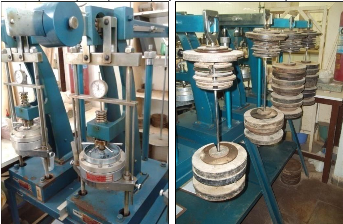
Figura 31 - Registro fotográfico do conjunto prensa, célula de adensamento e carregamentos.
