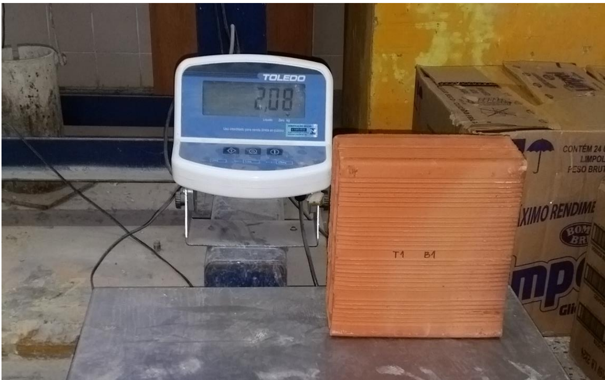
Figura 20 – Pesagem dos blocos de referência (tipo 1)
