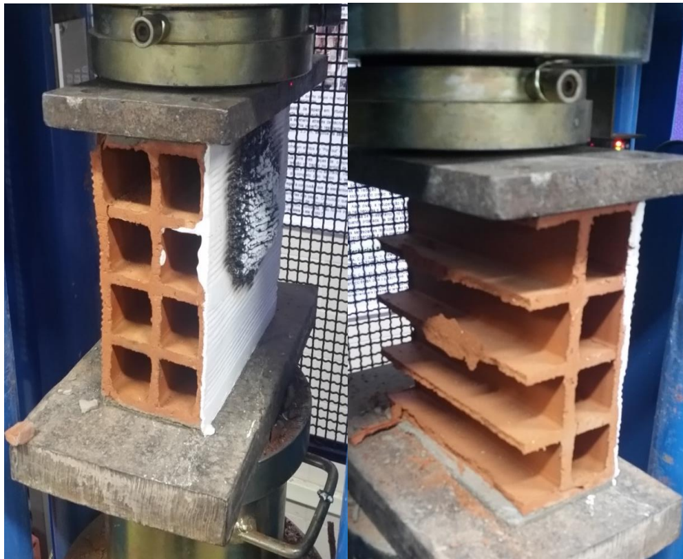
Figuras 32 e 33 – Ensaio de Resistência à Compressão (antes e depois) do bloco 15
