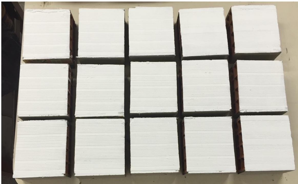
Figura 23 – Blocos do Tipo 3 após aplicação de 2 demãos de tinta intumescente.
