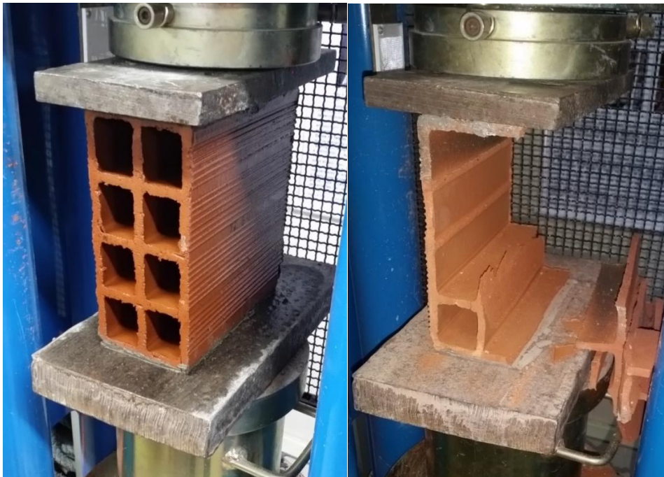
Figuras 35 e 36 – Ensaio de Resistência à Compressão (antes e depois) do bloco 15
