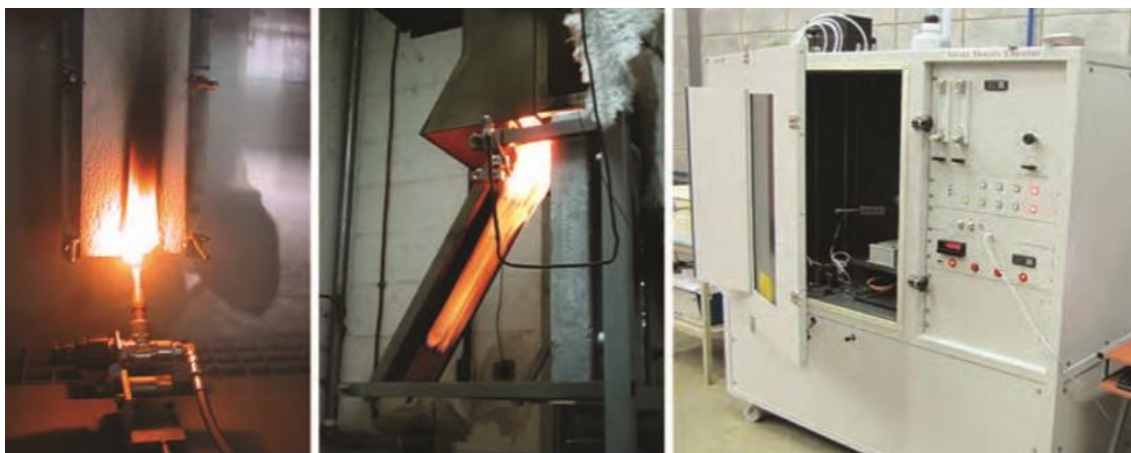
Figura 15 - Equipamentos para ensaios de ignitibilidade, propagação superficial de chamas e densidade ótica de fumaça.
