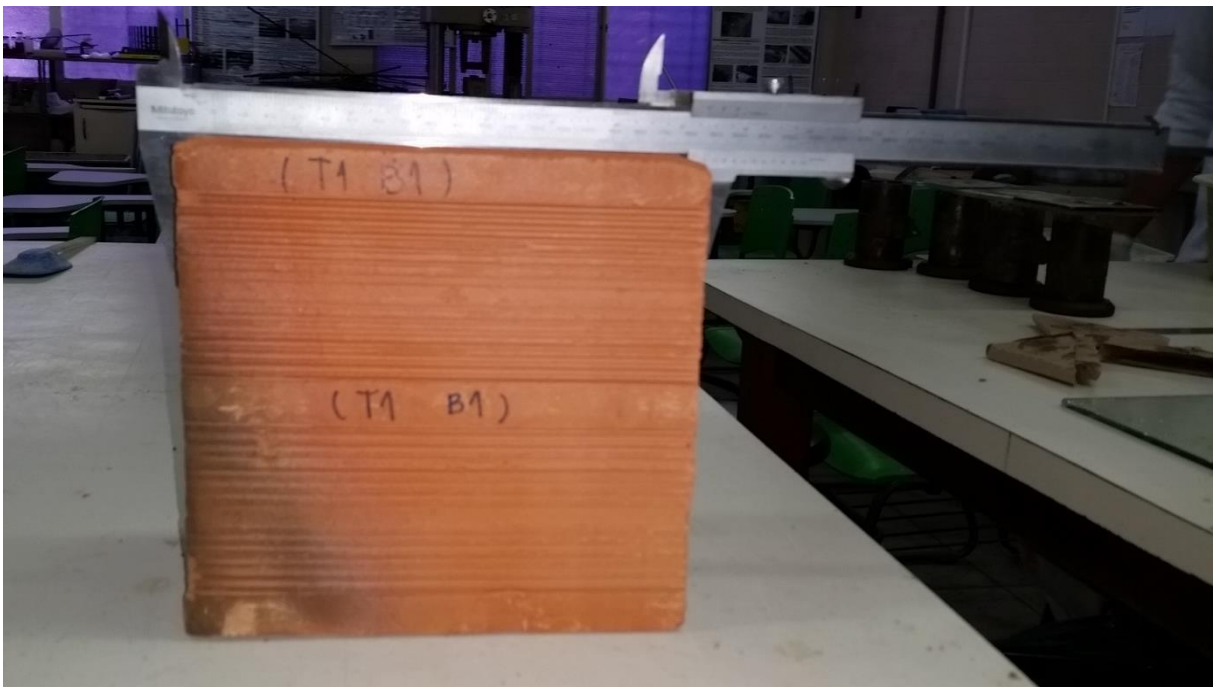
Figura 18 – Medição das principais dimensões dos blocos
