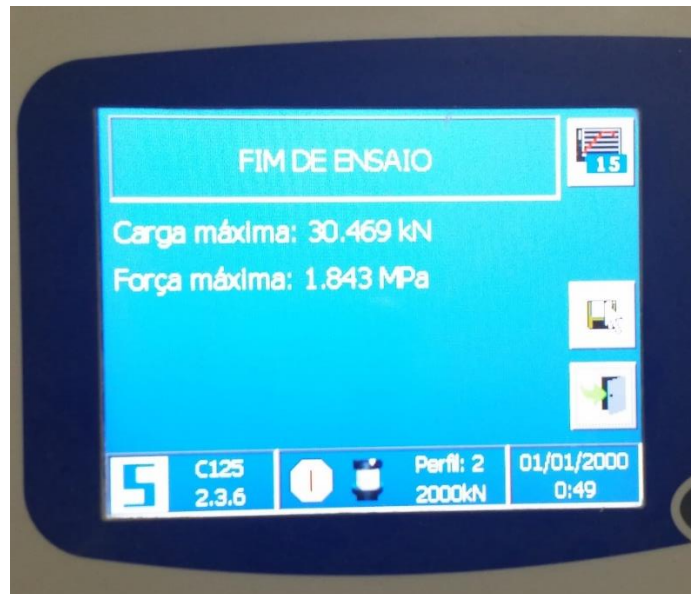
Figura 26 – Resultado do Ensaio de Resistência à Compressão do bloco 4
