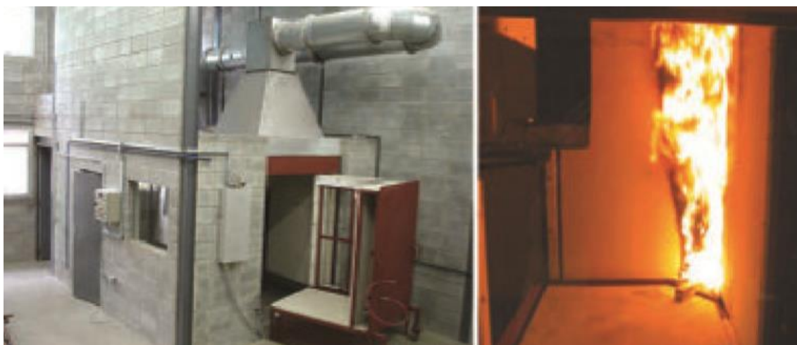
Figura 16 – Ensaio SBI – Single Burning Item de acordo com a EN 13823.
