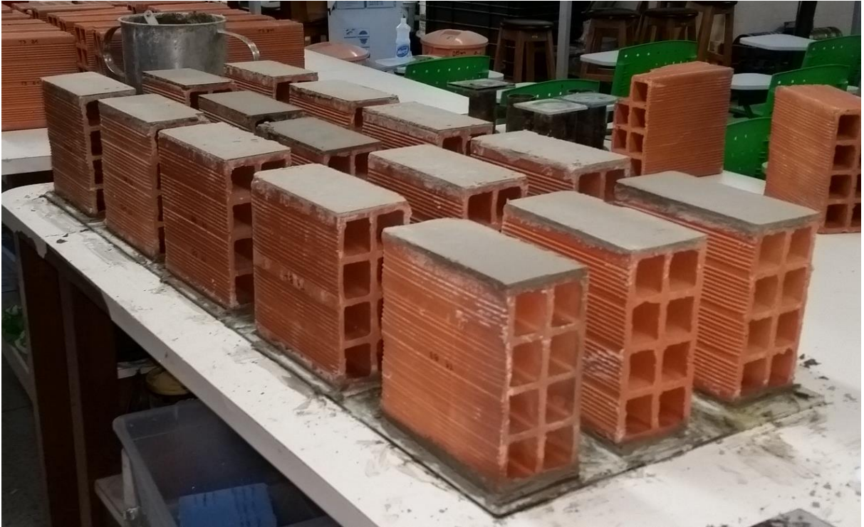
Figura 21 – Capeamento dos blocos de referência (tipo 1)
