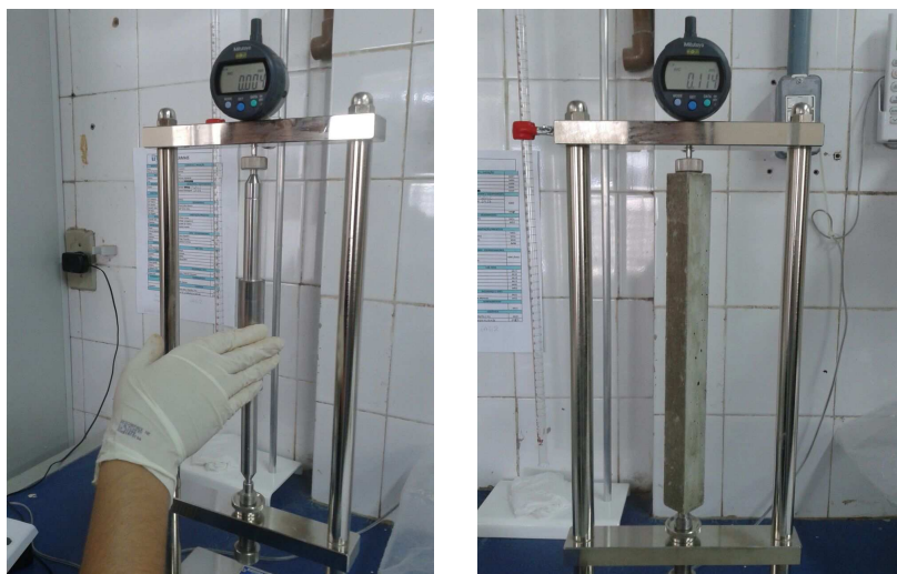
Foto 3.9 - Medições das expansões nas barras de argamassa.
