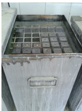
Foto 3.7 - Tanque de imersão.
