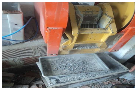
Foto 3.1 - Moagem do agregado.
