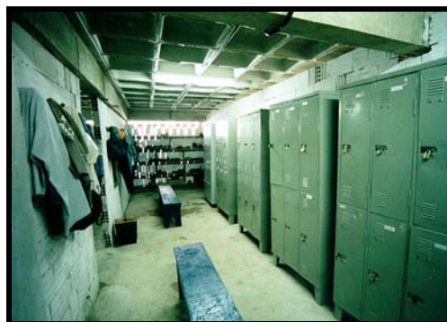
Figura 4.12 – Áreas de vivência – armários de madeira substituídos por armários industrializados de aço – melhoria no aspecto geral e conforto nos vestiários.
