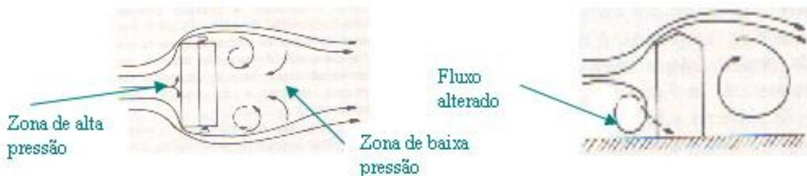
**Figura 22- desenho esquemático do fluxo de vento sobre uma parede**
