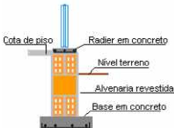
Figura 5-15 - Detalhe esquemático da fundação do protótipo (ITEP, 2007)
