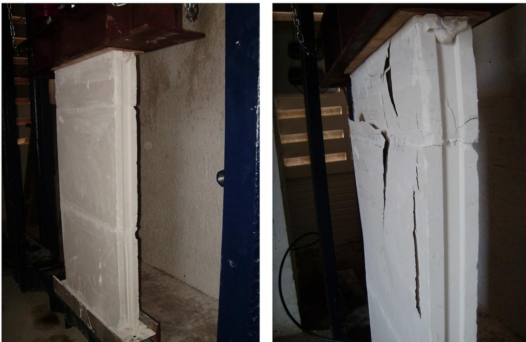
**Figura 5-17 - Paredinha antes e após a realização do ensaio de compressão (ITEP, 2007)**
