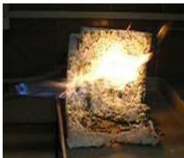
**Figura 3-14 - Bloco de isopor em contacto direto com a chama do Bico de Busen**
