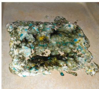
**Figura 3-15 - Bloco de isopor após a queima**
