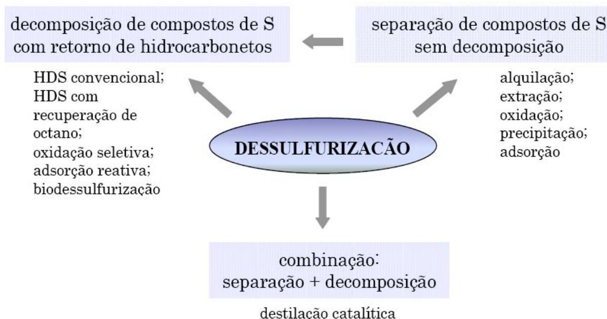
**Figura 6.** Classificação dos processos de dessulfurização baseada na transformação dos compostos orgânicos de enxofre. Babich e Moulijn (2003).
