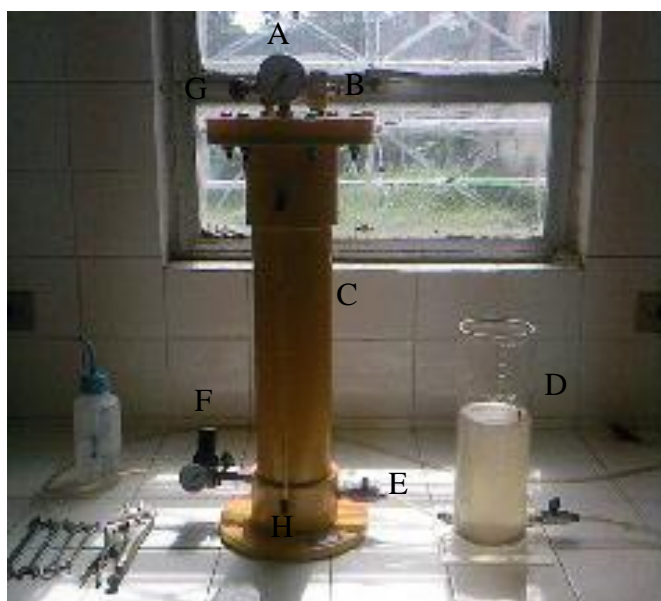
Figura 7 – Flotador por ar dissolvido. A: manômetro; B: entrada de água; C: cilindro homogeneizador; D: tanque; E: válvula de controle de saída do ar; F: válvula de controle de vazão; G: válvula de alívio; H: medidor de nível
