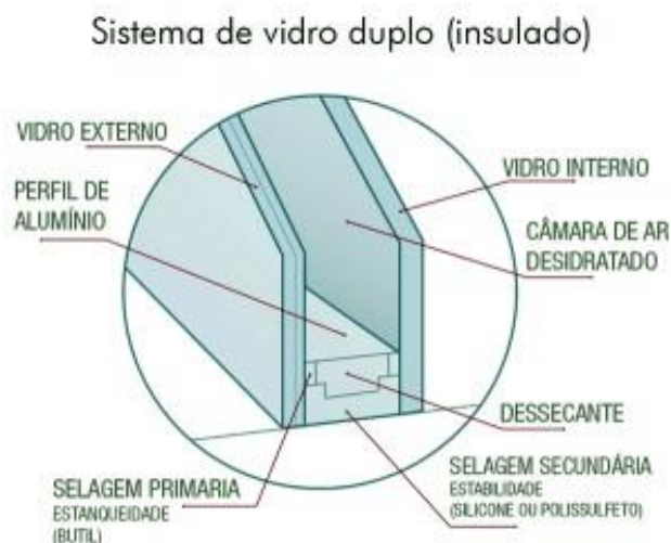
Figura 21 – Sistema de vidro insulado
