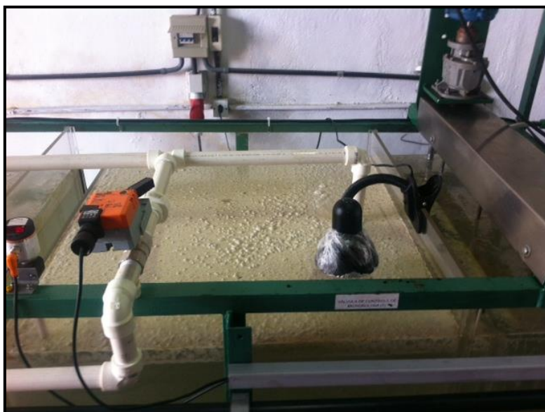
Figura 11. Fotografia da camada de densa camada de espuma oleosa formada na superfície livre da câmara de flotação após a implantação da estratégia de controle de nível.
