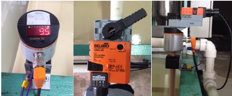
Figura 5. Elementos de controle (conjunto sensor / válvula).
