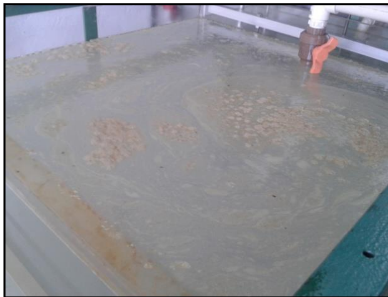
Figura 10. Fotografia da camada de espuma oleosa formada na superfície livre da câmara de flotação antes da implantação da estratégia de controle de nível.
