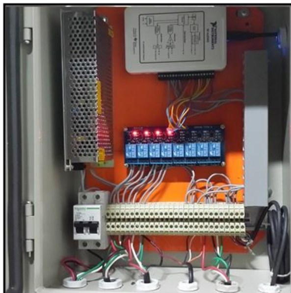
Figura 4. Placa de comando e aquisição de dados do sistema de controle.
