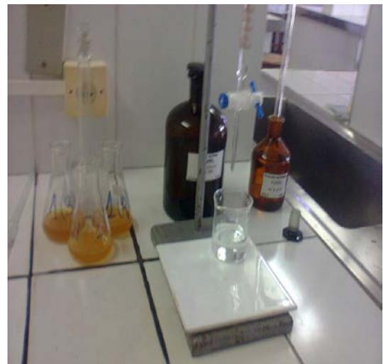
Os resultados são colocados individualmente por traço em planilhas e, se calculou a quantidade de íons de cloreto em cada amostra que reagiu com a massa de cimento de acordo com o traço (pobre, médio e rico) e a profundidade de penetração (1, 2 e 3 centímetros) .
