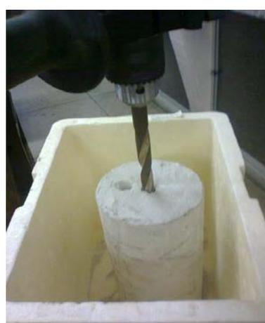
Figura 28: Ensaio de perfuração e ensacamento das amostras
