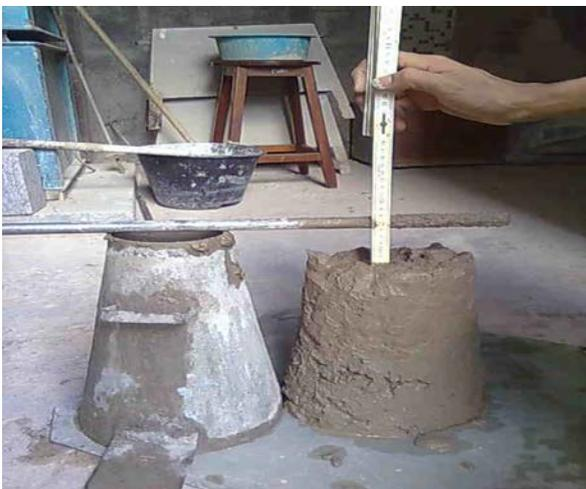
Fotografia 15: Moldagem dos corpos de provas.
