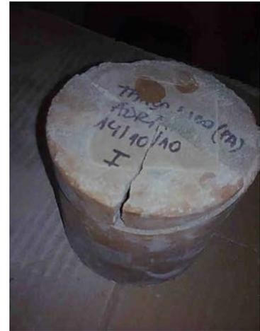
Os copos de prova foram acomodados em recipiente translúcido e sobre uma “cama” de brita (cascalhinho), para não estarem em contato direto com o fundo deste e com água do mar cobrindo  $\frac{1}{2}$  (metade) das suas alturas. Todos foram colocados com uma das extremidades retificadas e não impermeabilizadas em contato direto com a água do mar.
