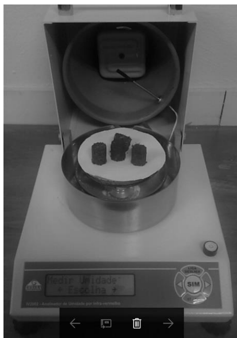
Figura 2: Determinação da umidade de briquetes produzidos a partir de resíduos da poda de macrófitas e resíduos de gesso hidratado
