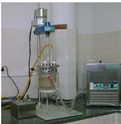
Figura 2 Biorreator de vidro de bancada com agitação e aeração controladas para obtenção do consórcio microbiano
