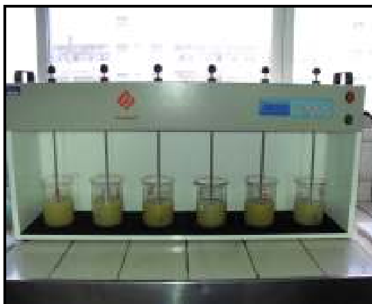
Figura 4 Tratamento físico-químico da manipueira no Jar test
