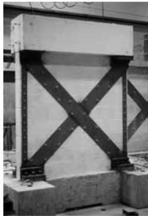
FIGURA 7 – BRACES VERTICAIS E DIAGONAIS (TAGHDI, 2000)
